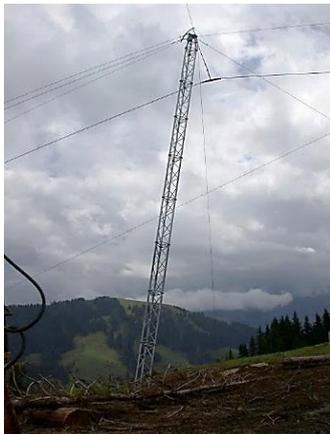
Le support artificiel fonctionne sur le même principe que le support incliné, mais on utilise alors un autre support qu'un arbre sur pied (par exemple, un tronc coupé ou un mât métallique). Les supports artificiels sont construits en forêt ou hors forêt, en terrain libre.
