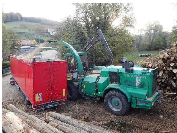
Chargement d'un camion à fond mouvant alternatif - FMA (Source : FCBA)
