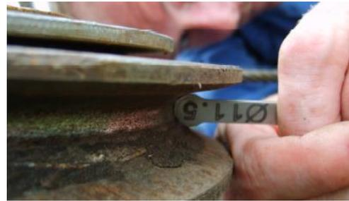
*Contrôle des poulies de guidage (Source : Valentini)*
