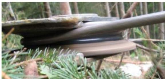
*Domage sur poulie suite à un angle de déviation horizontale supérieure à  $4^\circ$  (Source : Valentini)*
