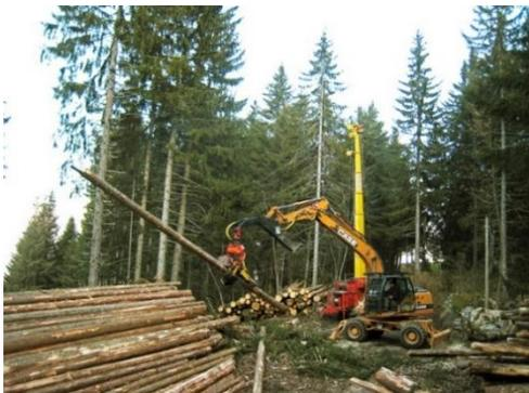
*Pelle TP sur pneus équipée d'une tête de façonnage
