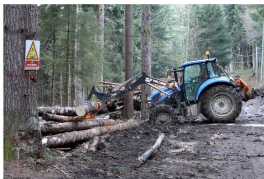
*Tracteur de reprise équipé d'une lame avant avec pinces télescopiques (Source : FCBA)*
