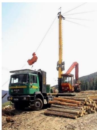
Ce type de matériel permet de transporter à la fois le mât mais aussi l'engin de reprise sur la plateforme du camion. Deux équipements fonctionnent en France et deux en Suisse romande.
