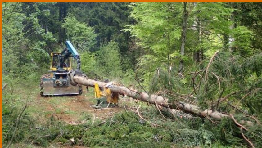
Façonnage mécanisé déporté par l'APOS (Source : FCBA)
