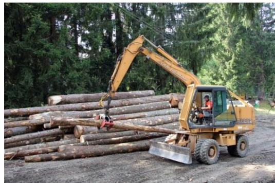
*Pelle TP sur pneus équipée d'un grappin
