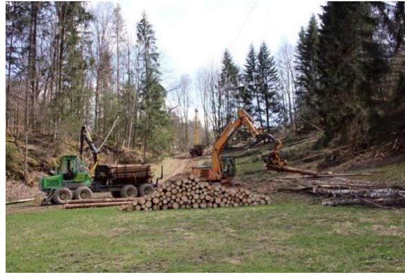
*Dans cette configuration, c'est le chauffeur de la pelle qui utilise en alternance le porteur pour rapprocher quelques produits en bord de route.*
