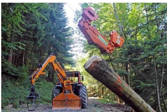
*Tracteur de reprise équipé d'une grue mais très limité par le volume des grumes. Nécessité de billonner avant manutention (Source : FCBA)*
