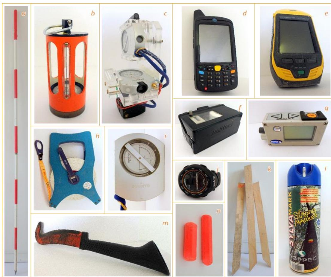
Matériels utilisables pour le tracé d'une ligne de câble → jalon(a), boussole(b), minithéodolithe(c), terminal de saisie portable(d), récepteur GNSS avec correction différentielle (e), topofil (f), télémètre (g), décimètre(h), clinimètre(i), altimètre (j), piquets de bois (k), bombe de peinture (l), serpe (m), craie forestière (n)
