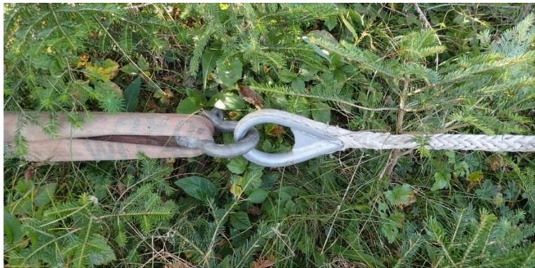
*Jonction d'un ancrage et d'un hauban synthétique (Source : FCBA)*
