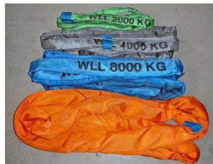
*Ceintures d'ancrage : Couleur et charge d'utilisation maximale
