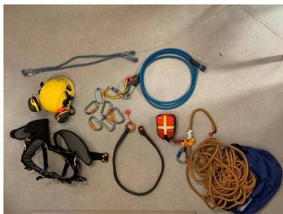
Photographie d'un sac de grimpe complet (sauf grimpettes) pour la mise en place d'un câble
