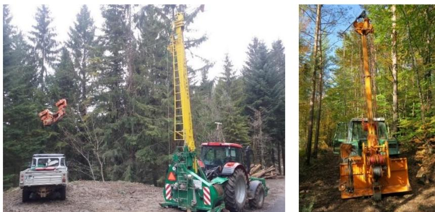
*Câble mât monté sur un tracteur agricole (Source : FCBA)*
