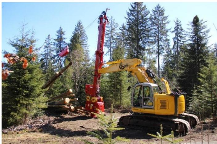
Câble mât Grizzly monté sur une pelle mécanique (Source : Herzog Forsttechnik)
