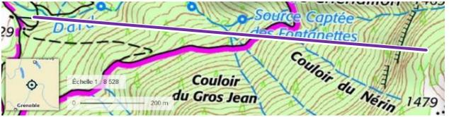
Calcul de l'azimut à suivre pour piqueter une ligne de câble après ajustage de la boussole (Source : ONF, [www.geoportail.gouv.fr](http://www.geoportail.gouv.fr), IGN)
